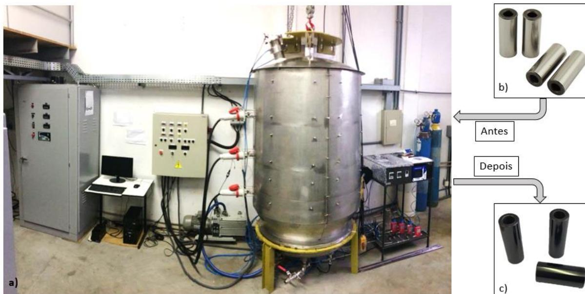
Figura 64 - a) Equipamento industrial presente na Plasmar Tecnologia e detalhe do pino do pistão b) antes e c) depois da deposição do revestimento.
