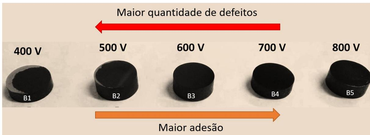
Figura 46 - Aspecto visual das amostras após a deposição de intercamadas contendo Si em diferentes tensões e posterior filme de DLC.
