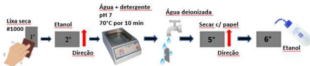
Figura 12: Ilustração das etapas de preparação do substrato. Fonte: elaborada pelo autor.
