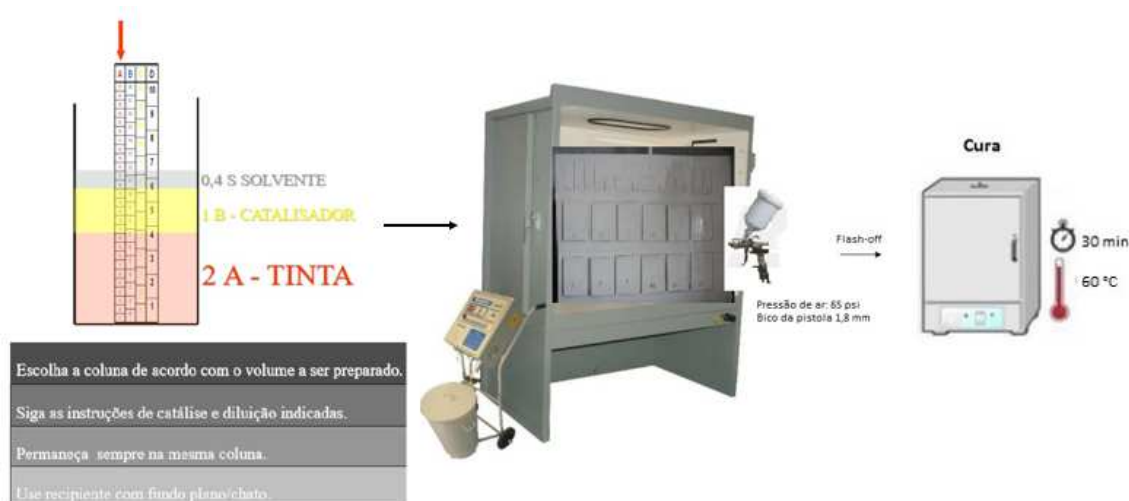
Figura 14: Ilustração da preparação (diluição e catálise) e aplicação da tinta. Fonte: elaborada pelo autor.
