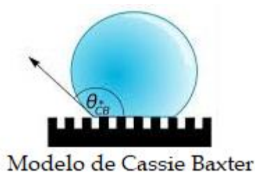
Figura 18. Molhamento da gota sobre a superfície rugosa segundo o modelo de Cassie Baxter. Adaptado de Cengiz; Cansoy (2014).
