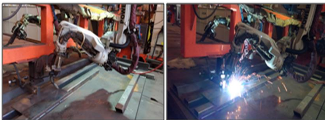
Figura 9. Robô de soldagem a arco – Modelo TM-1400W.
