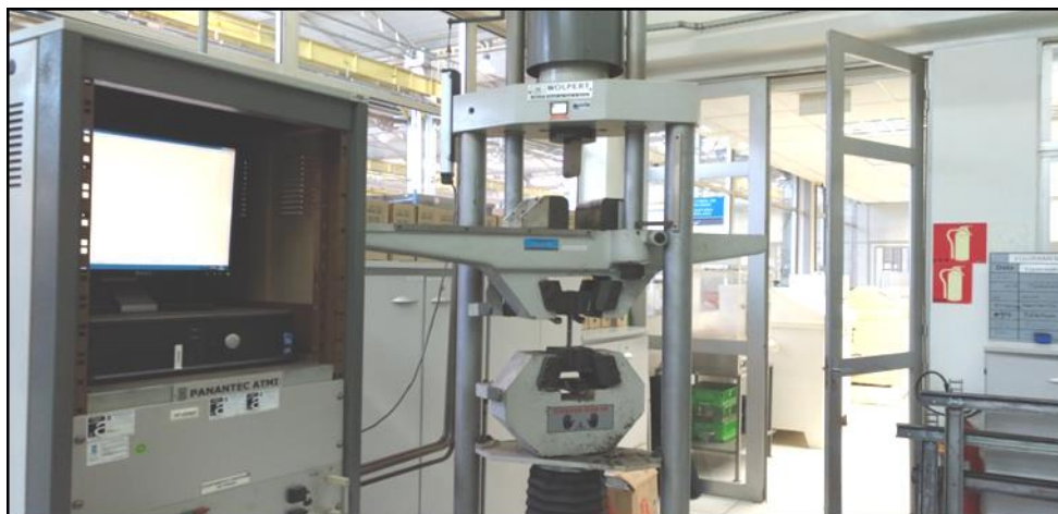
Figura 14. Máquina de ensaio universal Panantec,
