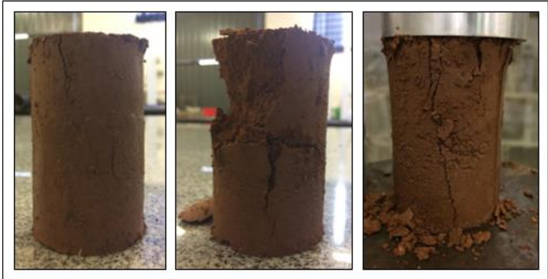
Figura 26 - Corpos de prova com uma camada de geogrelha de 65 kN/m após ruptura
