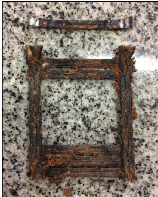
Figura 28 - Ruptura da geogrelha na segunda amostra
