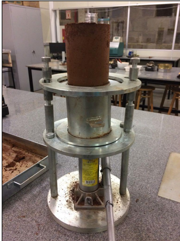
Figura 20 - Retirada do corpo de prova com o auxílio do macaco hidráulico
