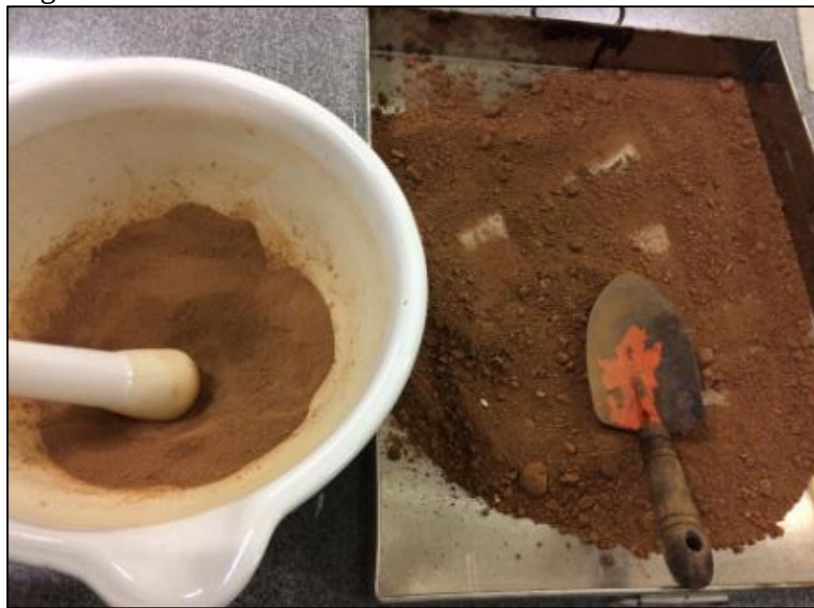
Figura 11 - Solo destorreado ao lado do solo em estado natural
