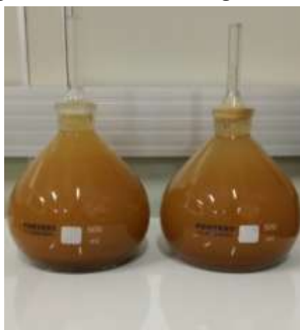
Figura 13 – Picnômetro + água destilada + solo
