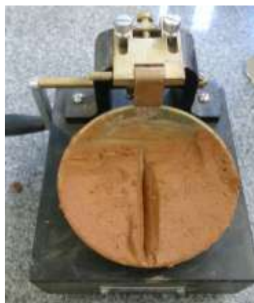
Figura 11 – Aparelho de Casagrande para a determinação do Limite de Liquidez.
