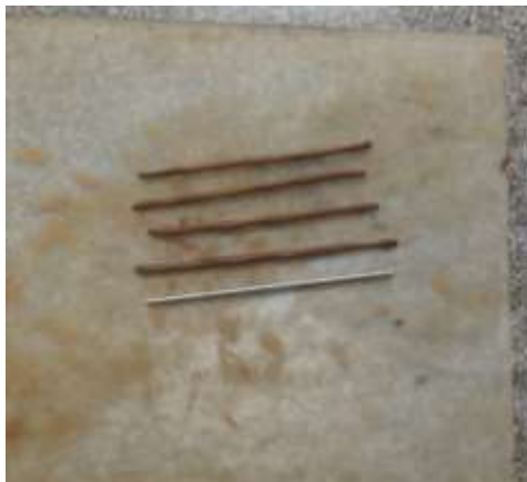
Figura 12 – Cilindros moldados no ensaio de Limite de Plasticidade
