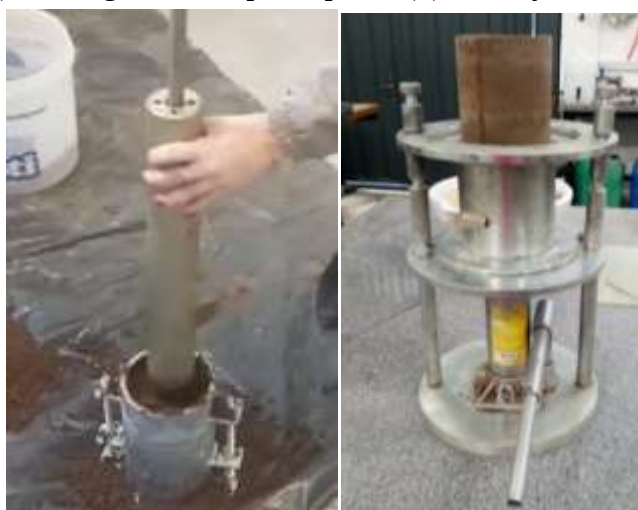
Figura 14 – (a) Moldagem do corpo de prova (b) Remoção do molde cilíndrico
