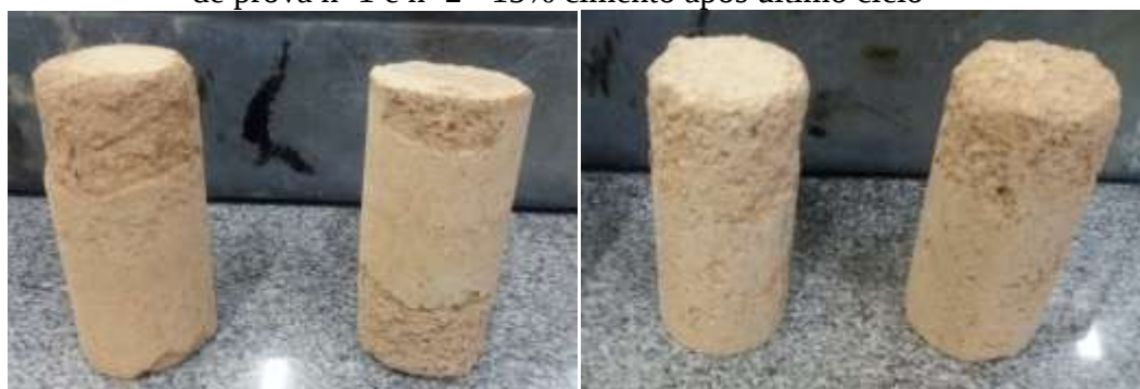
Figura 26 - (a) Corpos de prova n° 1 e n° 2 - 10% cimento após último ciclo (b) Corpos de prova n° 1 e n° 2 - 15% cimento após último ciclo
