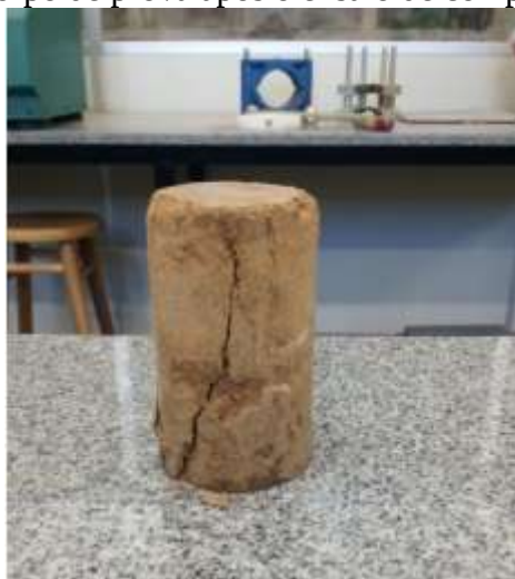
Figura 16 – Corpo de prova após o ensaio de compressão simples
