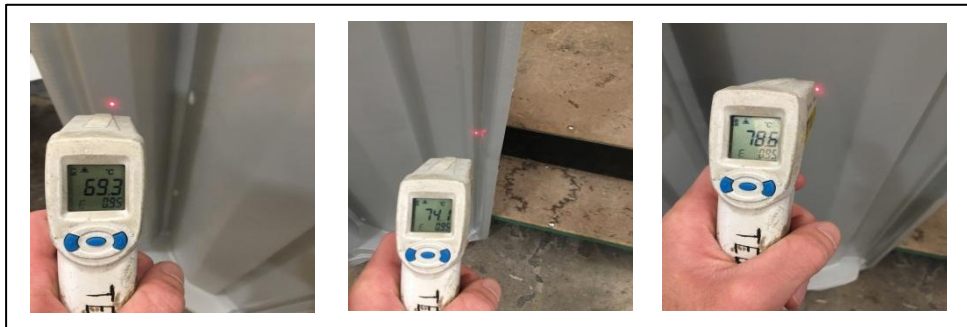
Figura 41 – Temperatura chapa de ABS para gravação
