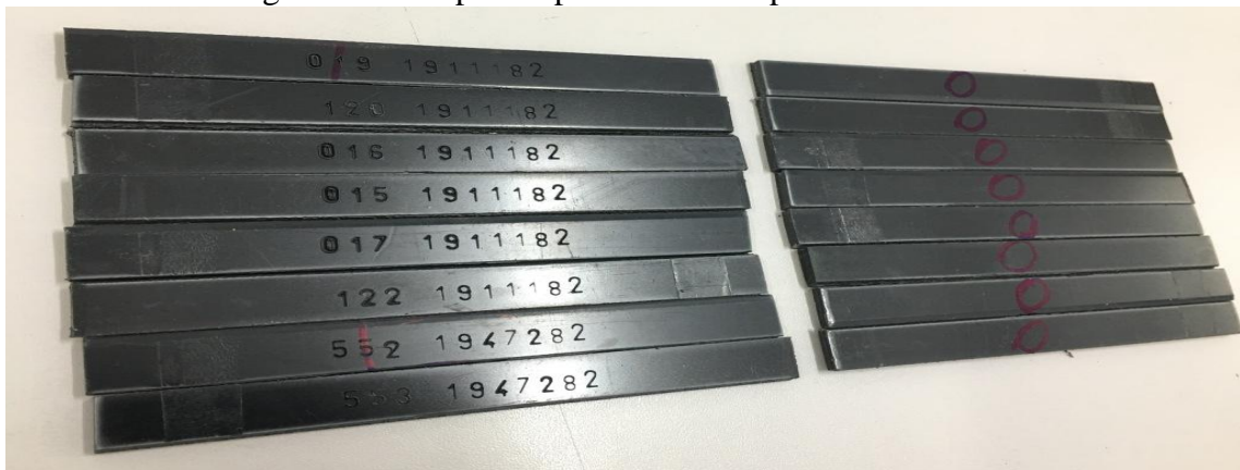
Figura 47 – Corpos de prova sentido oposto da extrusão
