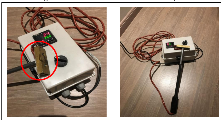
Figura 37 – Base de cobre com resistência aquecida
