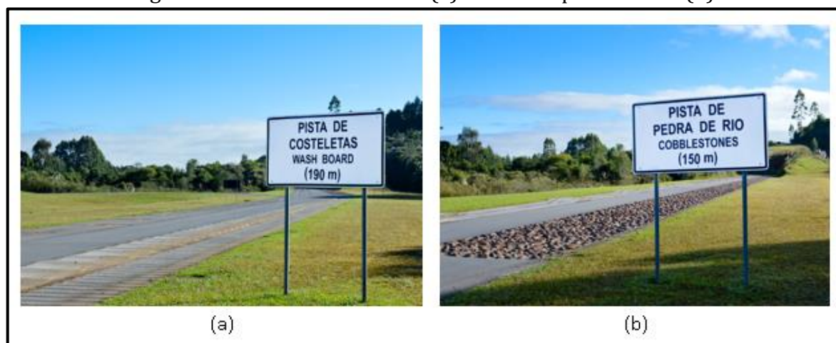
Figura 22 – Pista de costeletas (a) e Pista de pedra de rio (b).
