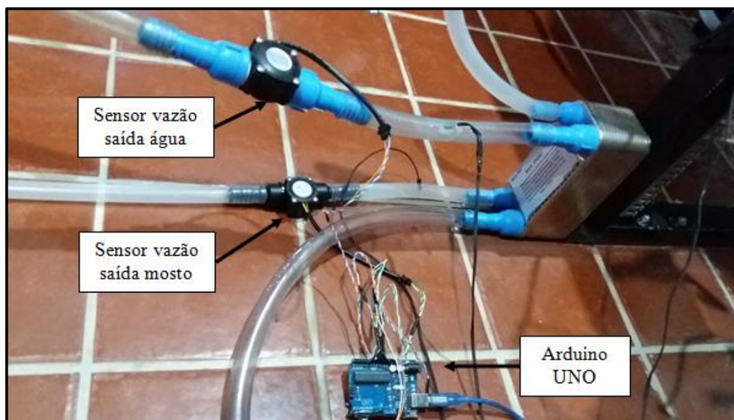
Figura 20 - Montagens dos sensores de fluxo
