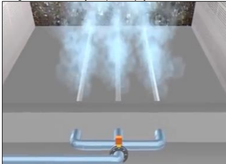
Figura 4 – Tubulações para injeção de ar no reator
