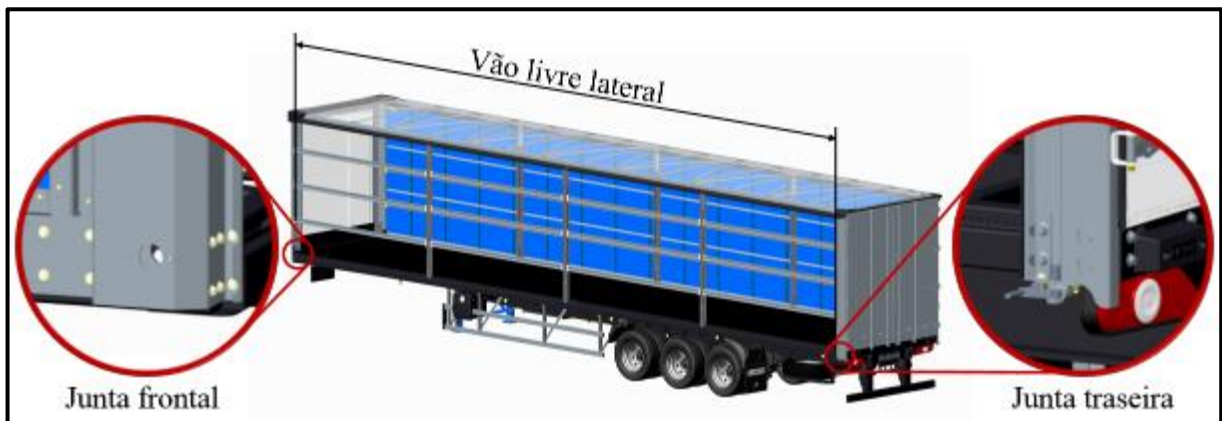
Figura 7 – Juntas aparafusadas frontal e traseira de implemento sider .
