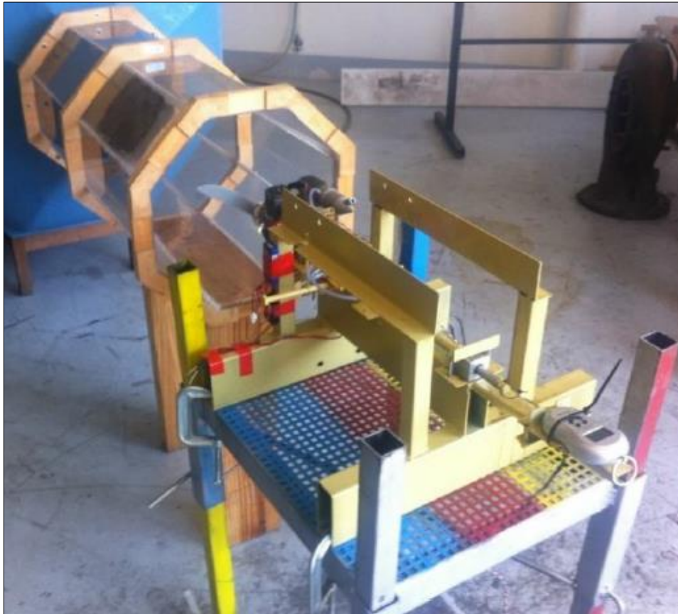
Figura 21 – Seção de testes do túnel de vento e o conjunto moto propulsor montado no dispositivo de testes
