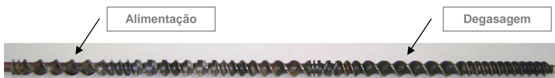
Figura 16: Conformação da rosca utilizada no processo de extrusão
