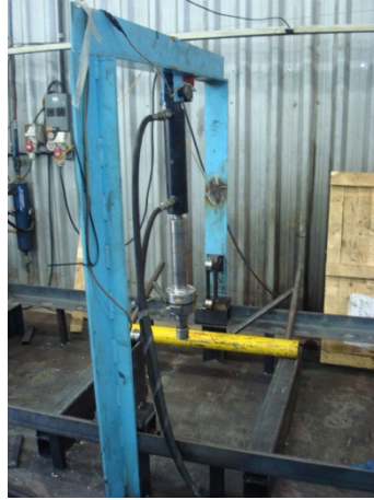
Figura 5 (a) – Ensaio de flexão: medidor de deslocamento linear
