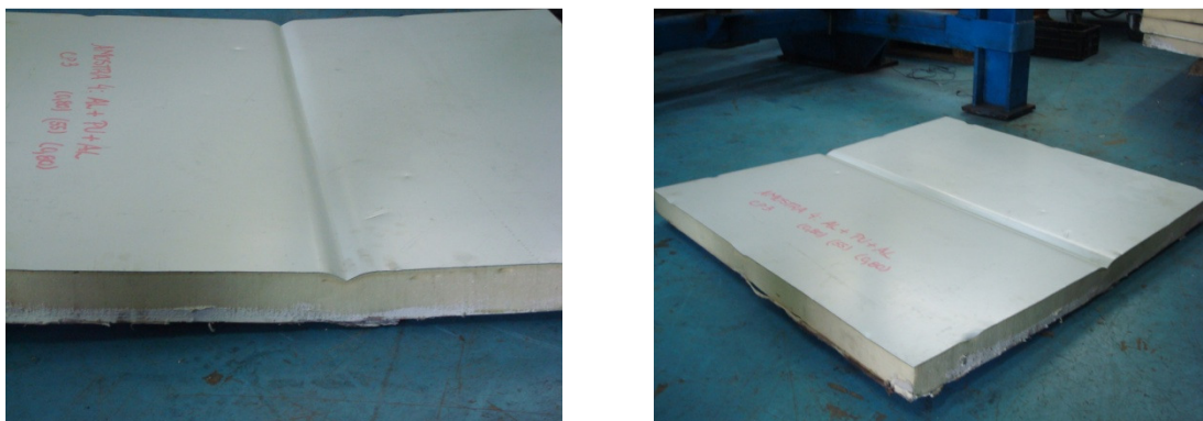
Figura 23: (a) e (b) Detalhe da deformação do compósito Al/PU/Al
