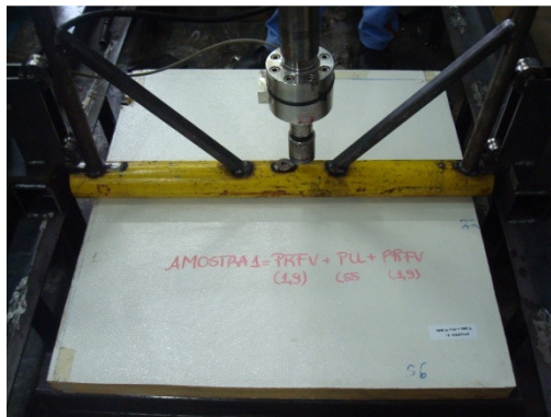
Figura 5 (b) – Ensaio de flexão: painel sanduíche montado
