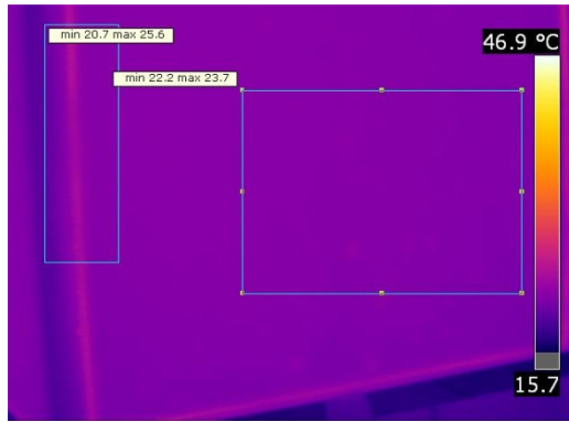
Figura 26: Distribuição de temperatura no compósito PRFV/PU/PRFV
