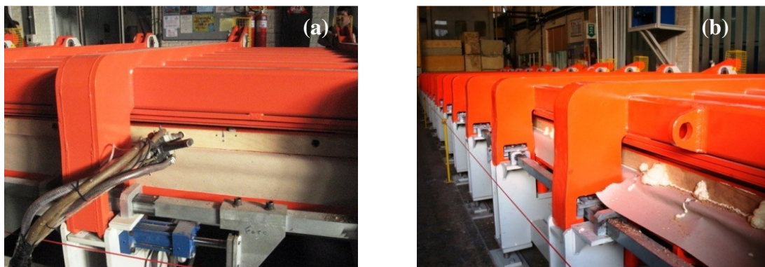
Figura 6 – Detalhamento da obtenção do painel sanduíche por injeção: (a) painel sanduíche sendo injetado e (b) painel sanduíche aguardando a cura do PU
