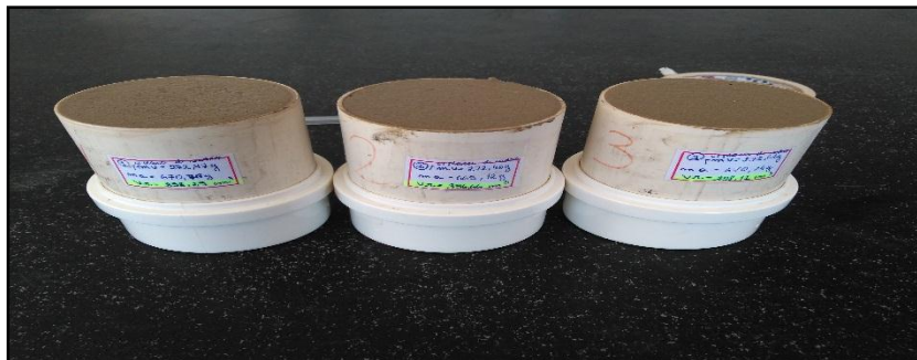
Figura 21 - Recipientes para ensaio de densidade de massa e teor de ar incorporado
