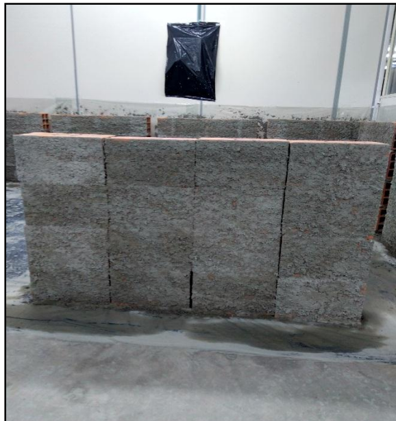
Figura 10 – Blocos chapiscados utilizados nos ensaios
