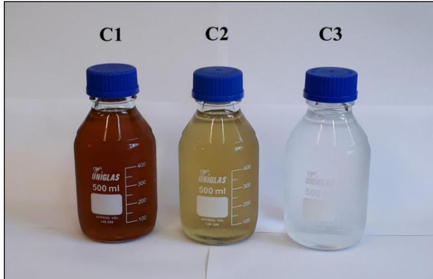
**Figura 33.** Aspecto da solução contida nos borbulhadores após os experimentos de gaseificação
