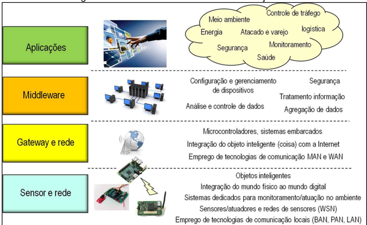
Figura 5 – Camadas funcionais de uma solução IoT
