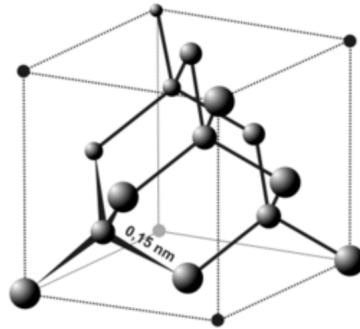
Figura 3: Estrutura cristalina cúbica de um cristal ideal de diamante.
