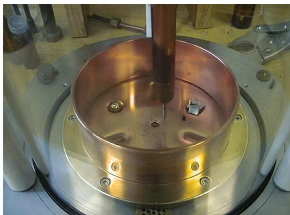
**Figura 3.2 : Esquema do forno de arco – voltaico utilizado para a produção de pastilhas da liga.**
