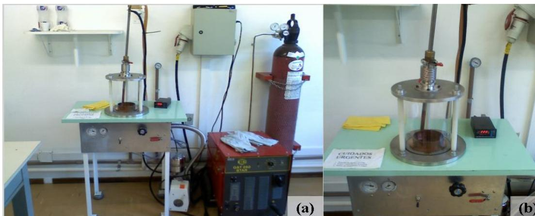
**Figura 3.3 : (a) Aparato experimental do forno de arco voltaico (campânula e fonte de corrente); (b) detalhe da campânula de confecção das amostras.**
