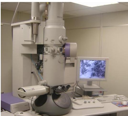
**Figura 3.15 : Microscópio eletrônico de transmissão Tecnai G2 Spirit 120 kV, com resolução de 0,2 nm da Dimat - INMETRO.**
