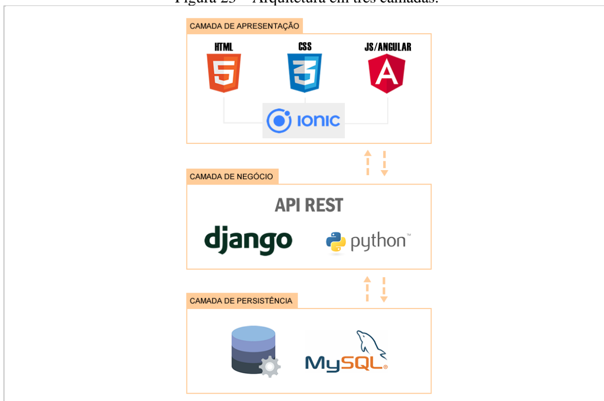
Figura 23 – Arquitetura em três camadas.
