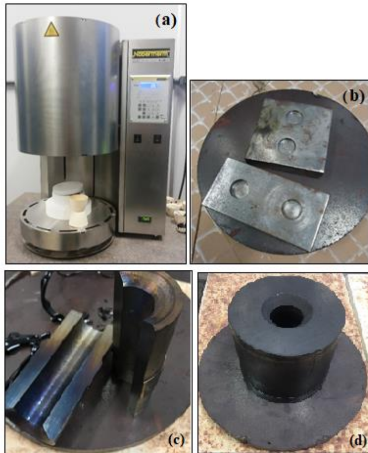
Figura 23 – (a) forno para fusão do basalto, (b) e (c) moldes metálicos e (d) molde de grafite.
