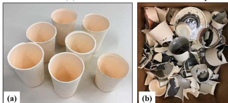
Figura 24 - (a) cadinhos de ZAS e (b) cadinhos de ZAS descartados depois de utilizados.
