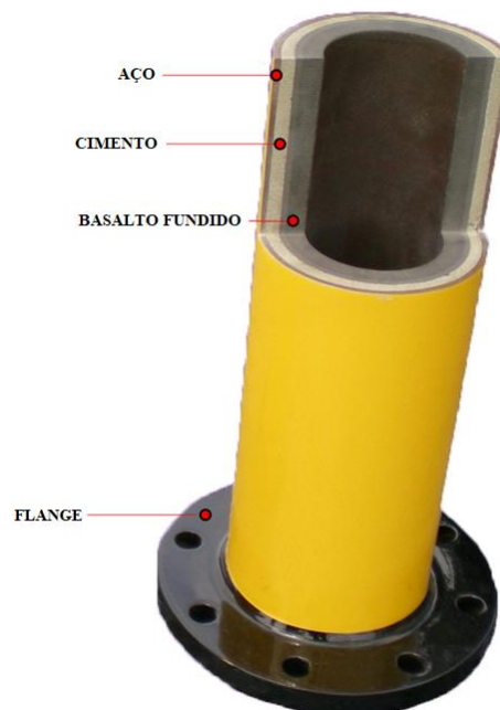
Figura 5 - Corte transversal de tubo de aço revestido internamente com basalto.
