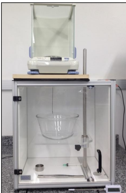
Figura 28 - Dispositivo de medição de Arquimedes para obtenção da massa submersa.
