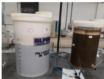
Figura 7. Reatores de lodos ativados
