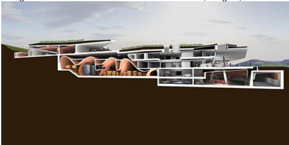
Figura 30 - Corte transversal da Cantina Antinori, Bargino, Toscana.
