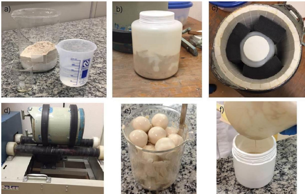
Legenda: a) batelada de matérias-primas, b) recipiente de polietileno, c) jarro de alumina maior, d) moinho – sistema mecânico, e) esferas de alumina  $Al_2O_3$  e f) suspensão obtida.
