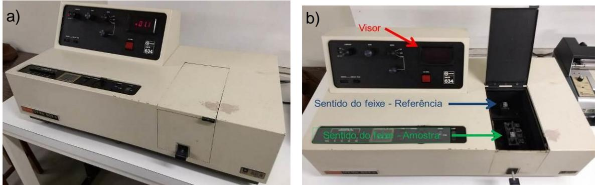
Para que fosse possível a utilização desse equipamento, foi necessária a criação de um suporte de adaptação especial para as amostras em pastilhas (Figura 23). Foi necessário ajustar a altura para garantir que a amostras recebessem o feixe de luz visível em seu centro, ponto de maior energia do equipamento. Esse suporte foi confeccionado usando-se placas de acrílico, utilizando revestimento frontal de coloração preta com orifício.
