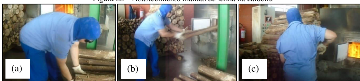
Figura 22 – Abastecimento manual de lenha na caldeira
