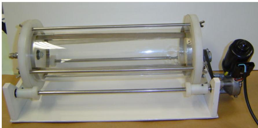
**Figura 11.** Montagem do casco do biorreator de tambor rotativo sobre o sistema de agitação.
