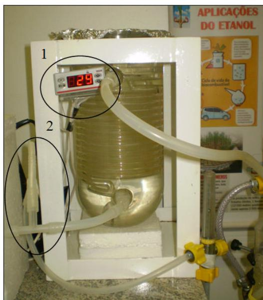
**Figura 14.** Banho termostático utilizado para aquecimento do ar injetado no biorreator. (1) termostato que regula a temperatura do banho; (2) conexão em “T” para inserção do termopar.
