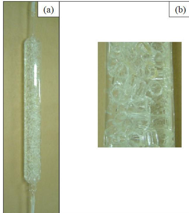
**Figura 13.** Aparato utilizado para umidificação do ar injetado no biorreator. a – Coluna umidificadora; b – anéis de Raschig.
