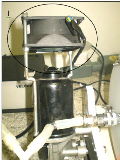
**Figura 12.** Motor do sistema de agitação do biorreator de tambor rotativo. (1) *cooler*.
