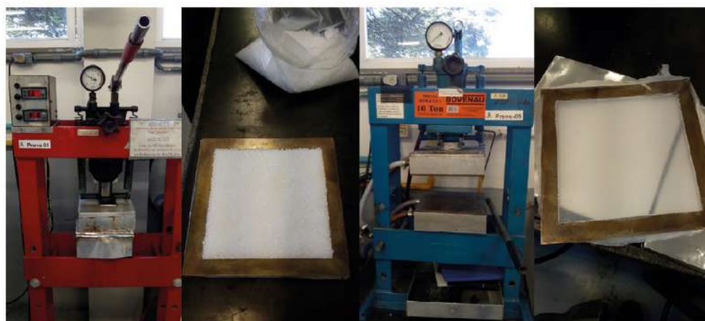
Figura 43 – Prototipagem de peças em polímero
