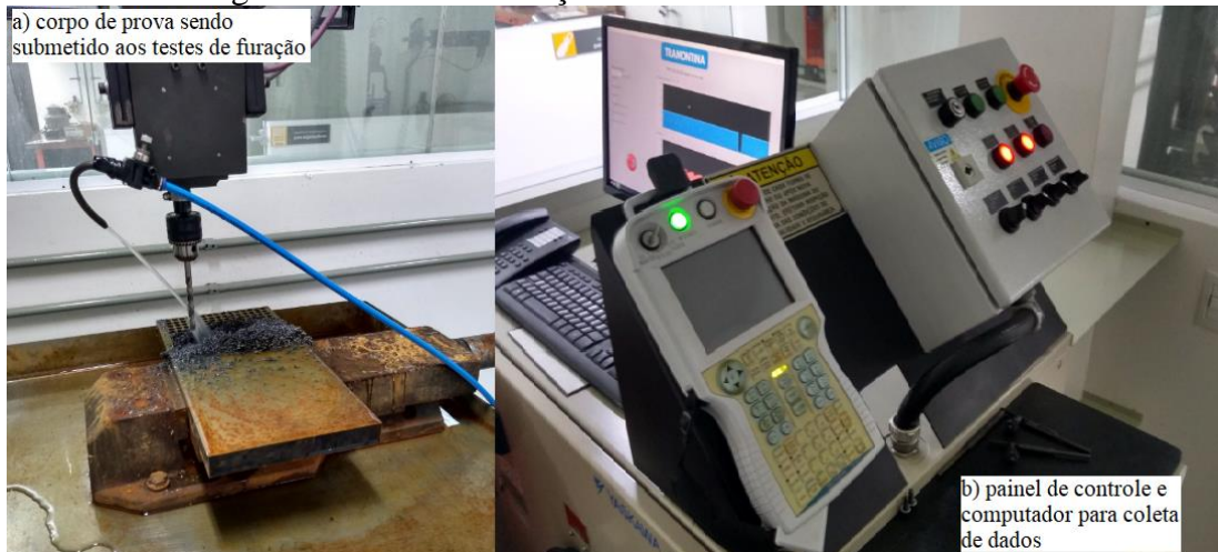
Figura 23 - Teste de furação em andamento no laboratório
