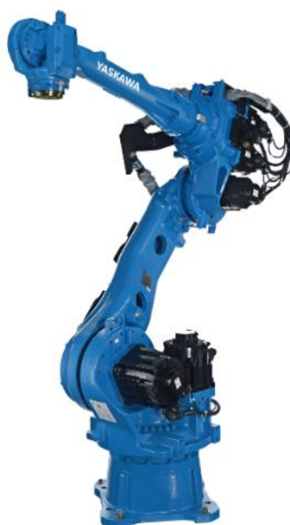
Figura 41 - Robô Motoman utilizado nos ensaios de furação
