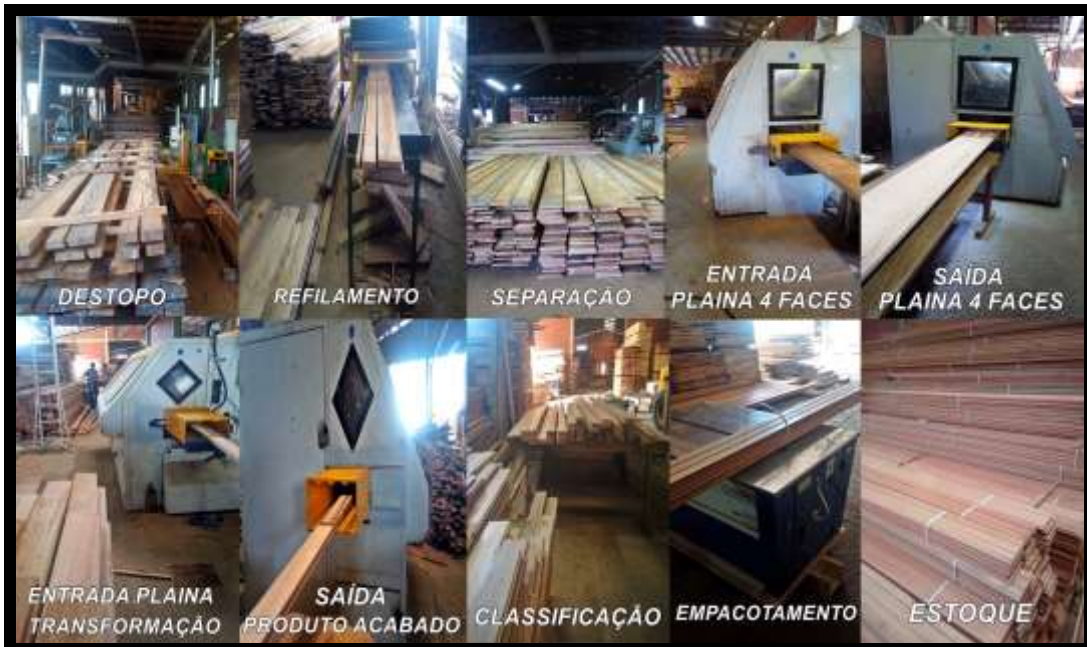
Figura 29 - Processo de transformação da madeira serrada bruta em madeira beneficiada e produto acabado
