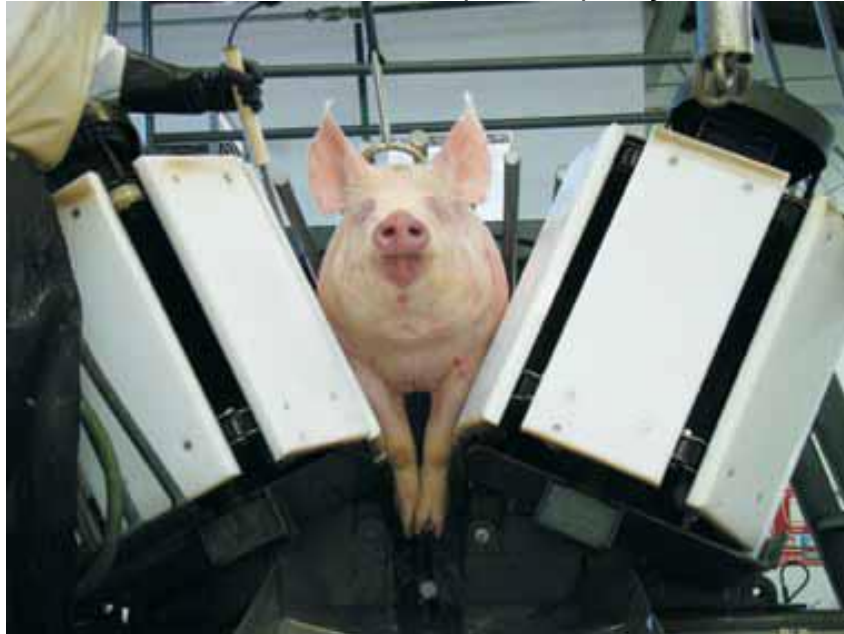
Figura 12: suíno imobilizado no restrainer para a aplicação dos eletrodos
