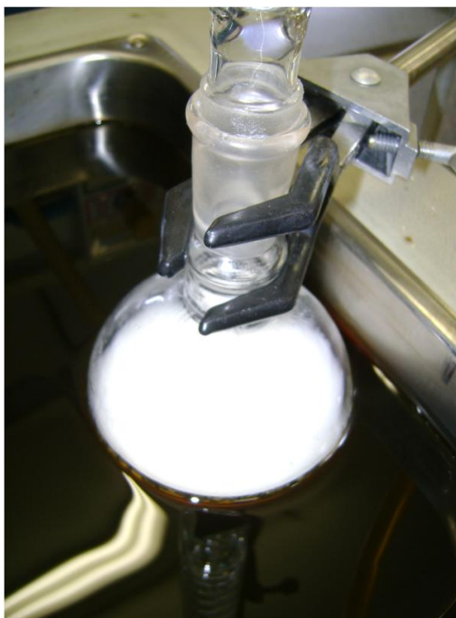
Figura 18: Detalhe do sistema de pós-cura do TPU.
