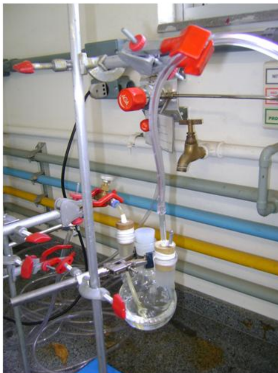
Figura 14: Sistema de saturação de N 2 com vapor de MEK.
