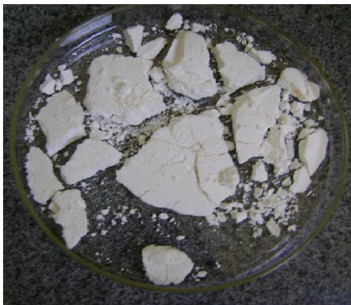
Figura 21: Amostra de TPU sintetizado após remoção do solvente.
