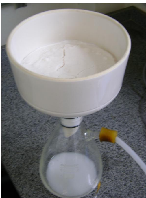
Figura 19: Filtragem a vácuo do TPU sintetizado.
