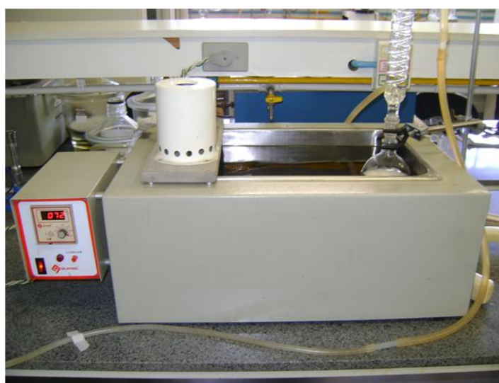
Figura 17: Sistema de banho de óleo para pós-cura do TPU.
