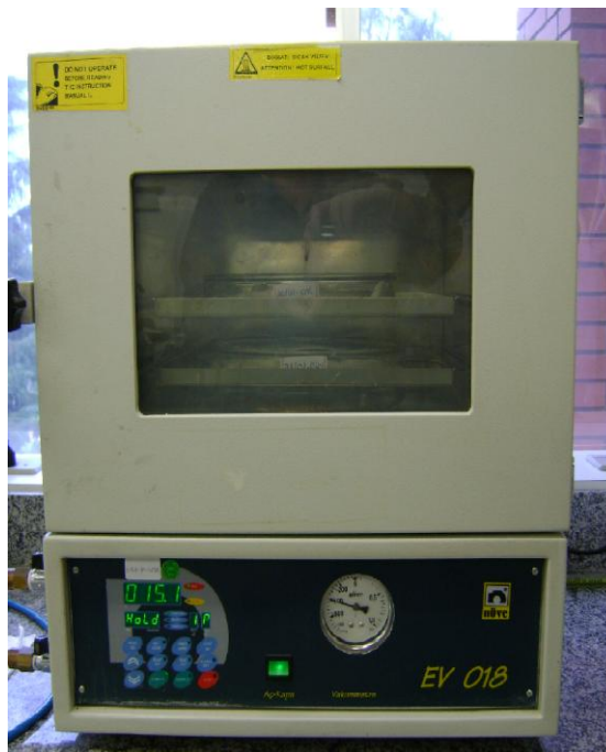
Figura 20: Secagem das amostras de TPU em estufa a vácuo.
