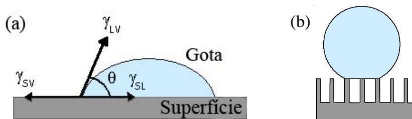
Figura 23 – Ação de forças em uma gota depositada em uma superfície sólida (a) e representação de uma gota sobre uma superfície rugosa, segundo o modelo de Cassie-Baxter (b)
