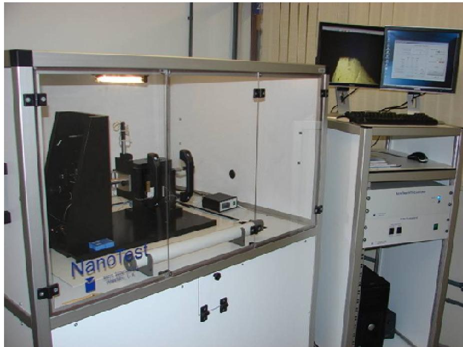
**Figura 25.** Nanoindentador localizado no laboratório de propriedades mecânicas da UCS. O monitor da esquerda representa uma imagem de microscopia óptica da seção-transversal do gume de uma broca com as indentações e o da direita o software de controle do equipamento.
