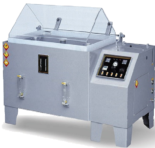
Figura 13 – Modelo de câmara utilizada para ensaios de névoa salina
