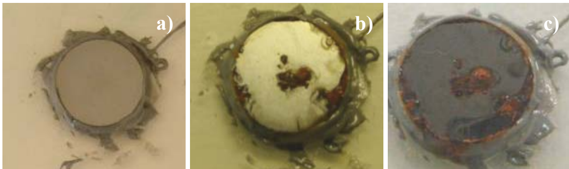
Figura 38 – Amostra tratada a 550°C e 90min a) antes b) após 24h e c) após 48h de ensaio de corrosão.
