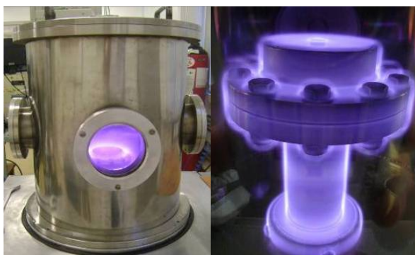
Figura 14 - Equipamento de oxidação a plasma no LESTT da UCS
