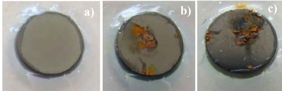
Figura 42 – Amostra tratada a 480°C e 90min a) antes b) após 24h e c) após 48h de ensaio de corrosão.
