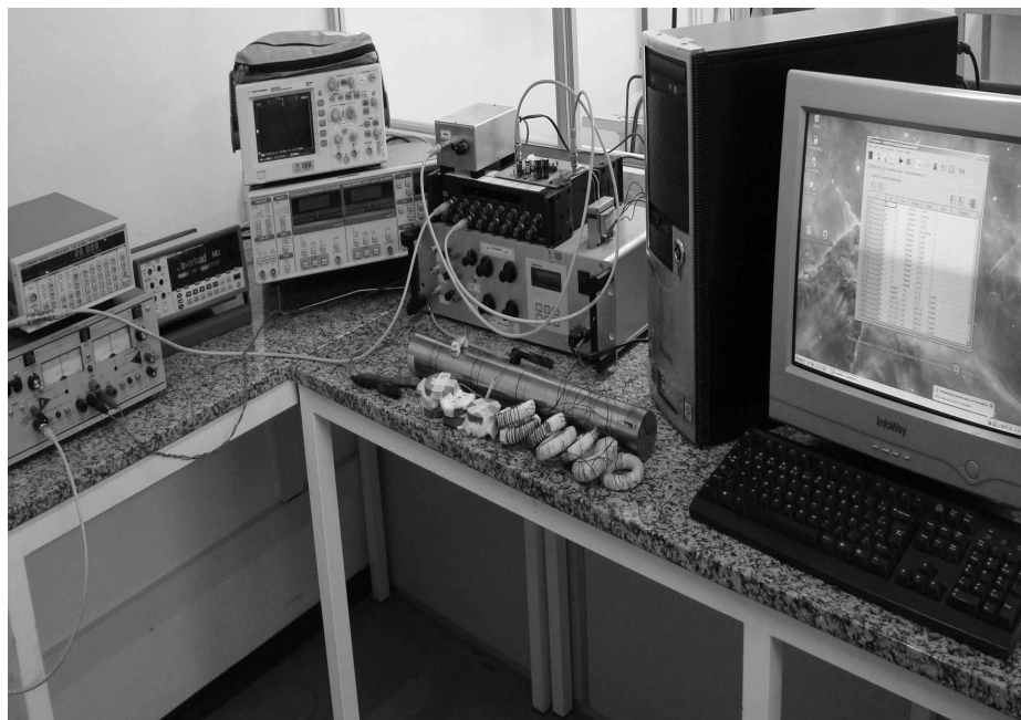
figura 3.7 – Equipamento para medidas de ruído Barkhausen
