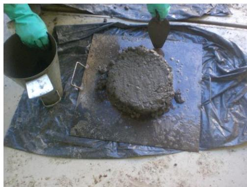
Figura 3.2 – Ensaio para medição de *slump* e Figura 3.3 – Ensaio para verificação da consistência.
