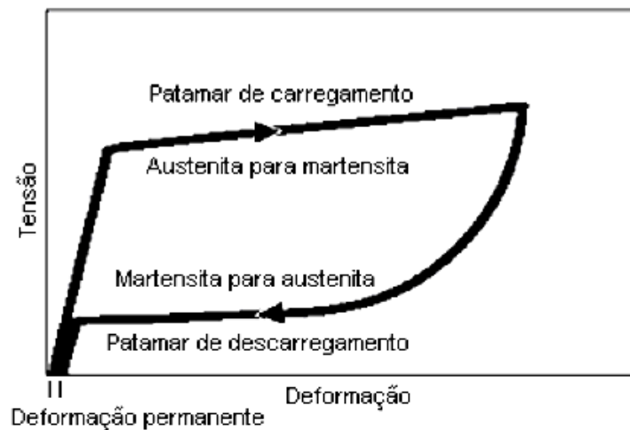
Figura 2 – Curva tensão-deformação esquemática para NiTi superelástico, adaptado [20].
