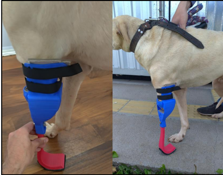
Figura 52 – Teste de utilização das próteses
