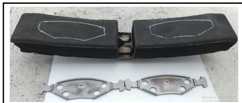
Figura 15 – Amostra do material de atrito retirada da sapata ferroviária
