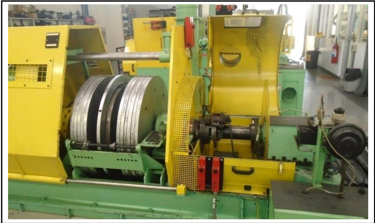
Figura 16 – Dinamômetro inercial para ensaio em escala reduzida
