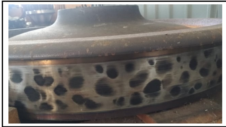
Figura 6 - Roda ferroviária com manchas térmicas
