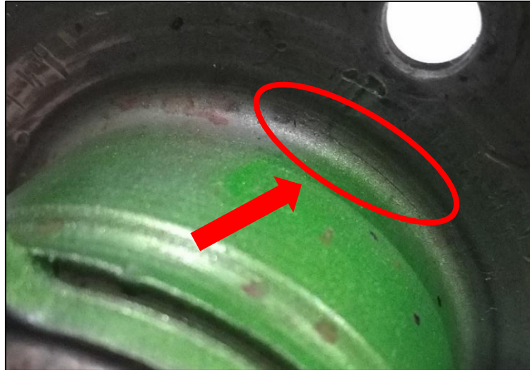
Figura 23 - Trinca visualmente perceptível na região de fratura do cubo.
