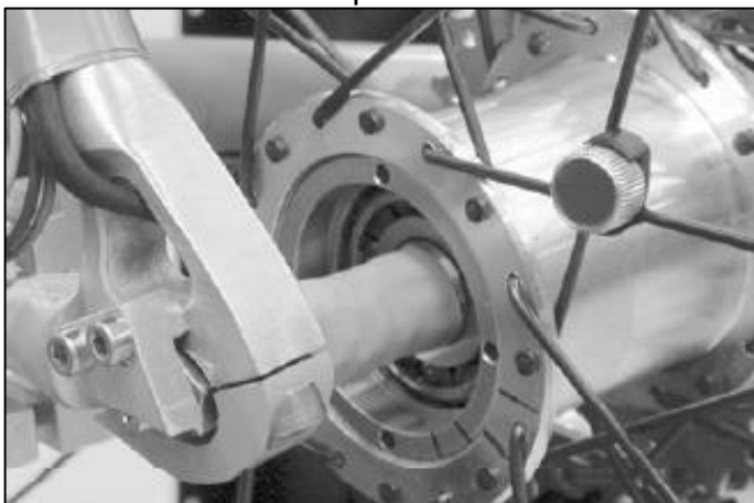
Figura 13 – Dinamômetro para roda traseira da bicicleta.
