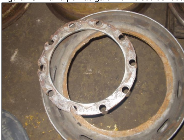
Figura 16 - Falha por fadiga em um disco de roda.
