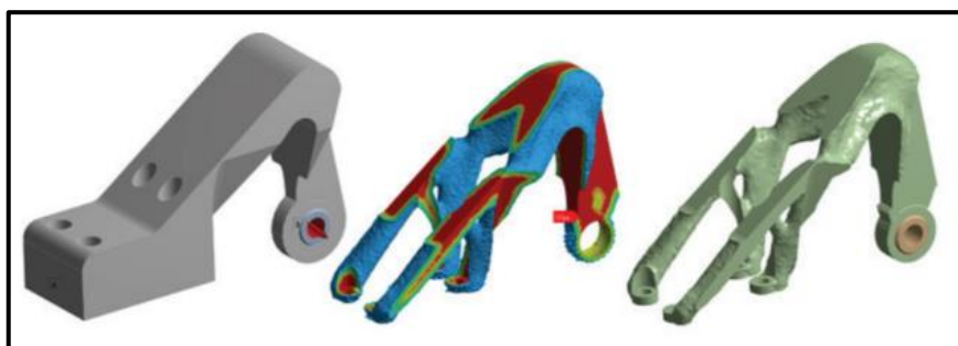
Figura 18 - Otimização topológica em um componente genérico
