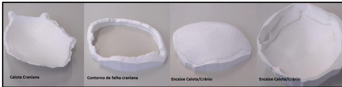
Figura 18 - Calota craniana e contorno de falha craniana impressas
