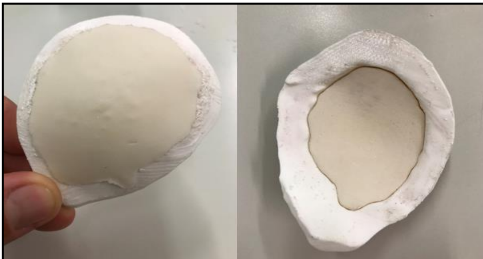
Figura 13 - Teste de encaixe da calota cranianas no defeito da falha.
