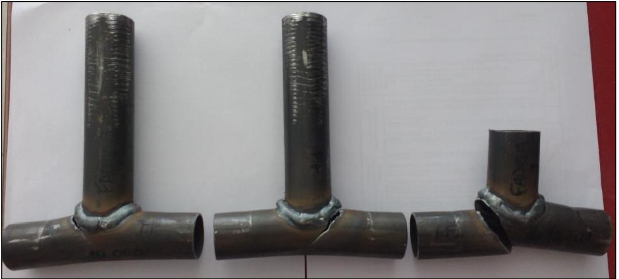
Apêndice C – Foto CP pós ensaio: Fadiga GTAW
