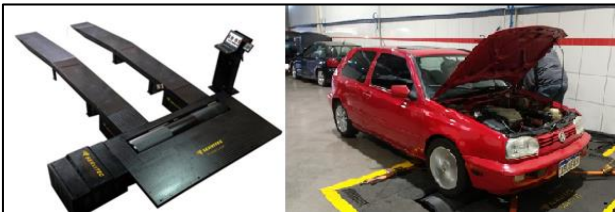
Figura 20 - Ensaio em dinamômetro de esteiras
