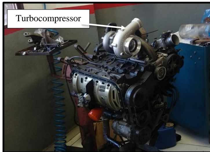
Figura 25 - Turbocompressor instalado ao motor
