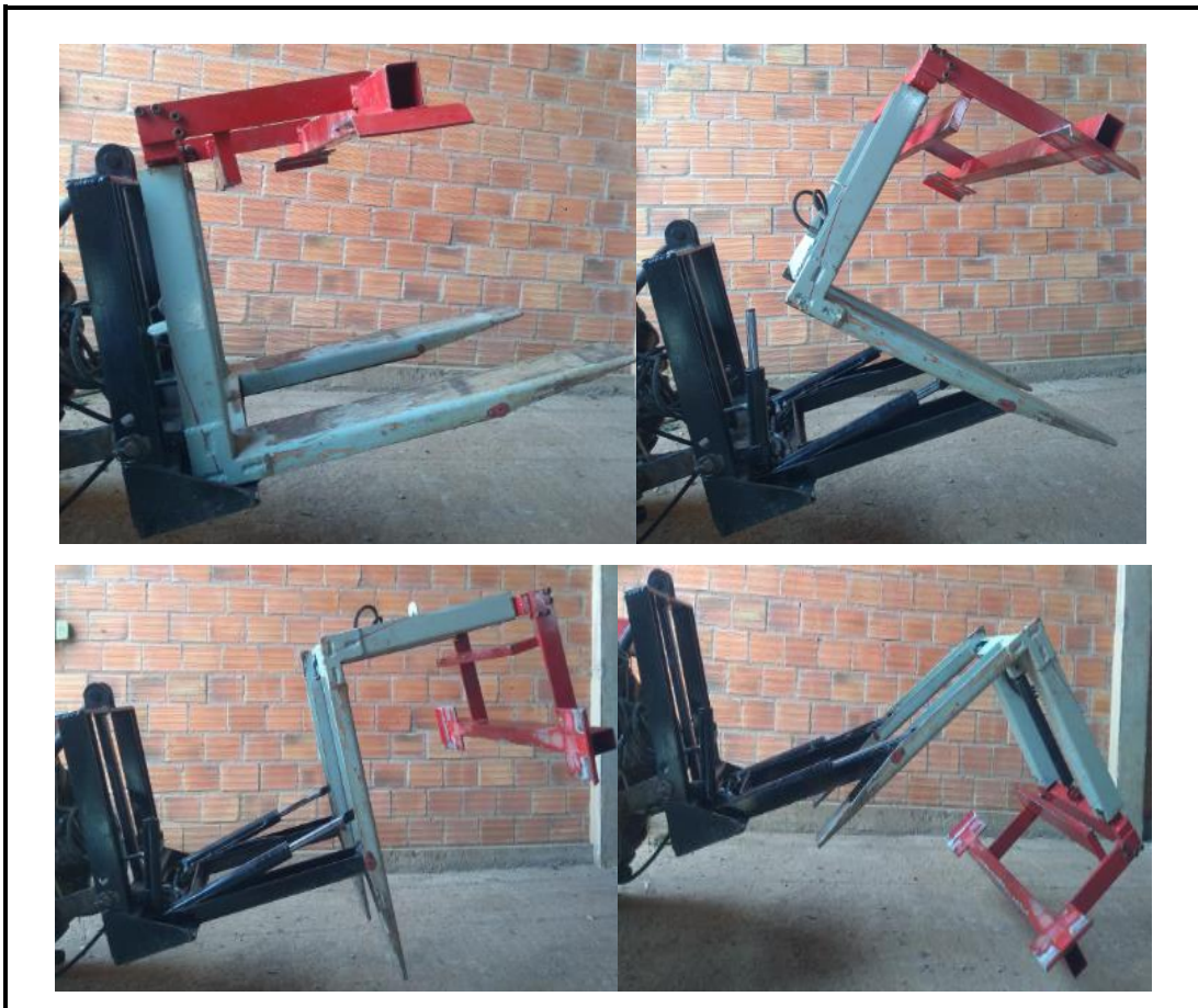
Figura 12 -Implemento tombador de bim
