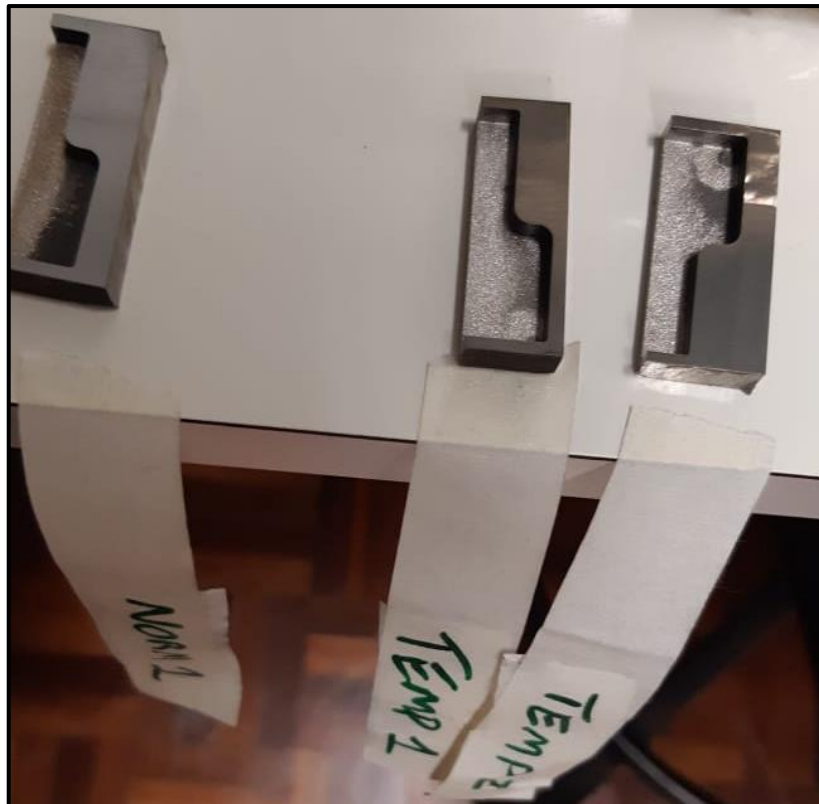
Figura 24 – Corpos de prova desembutados e atacados
