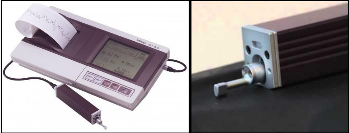
Figura 18 – Sistema de aferição de rugosidade
