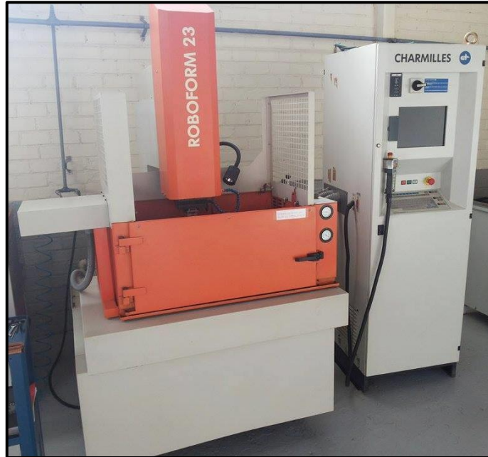
Figura 16 – Máquina de eletroerosão por penetração ROBOFORM 23
