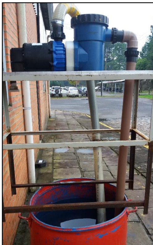
Figura 15 - Bancada para teste de escorvamento
