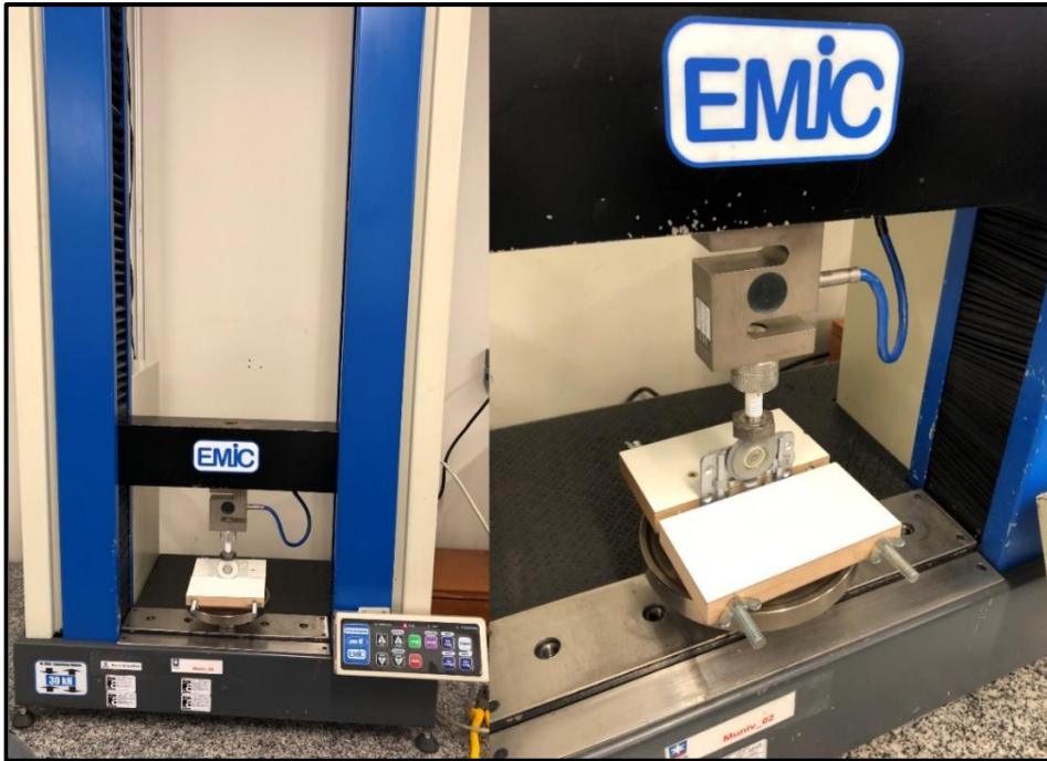
Figura 15 - Equipamento e dispositivo de fixação para obtenção da rigidez dos mecanismos
