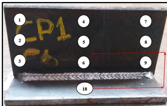
Figura 34 – Pontos de verificação dimensional e fixação dos corpos de prova para soldagem
