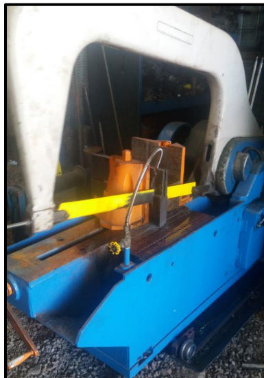
Figura 21 – Máquina utilizada no processo de corte dos corpos de prova
