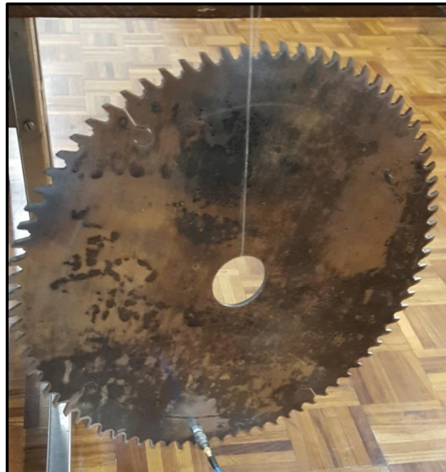
Figura 15 - Suspensão das lâminas para ensaio de corpo livre
