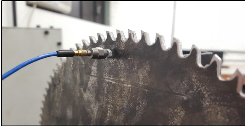
Figura 16 - Fixação do acelerômetro
